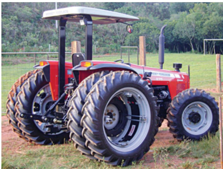
Máquina equipada com Rodado Duplo de Engate Rápido
