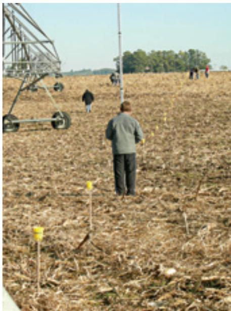
Alunos fazendo levantamento altimétrico prévio na área onde será realizado um estudo sobre uniformidade de aplicação de lâmina de irrigação em um Pivot Central
