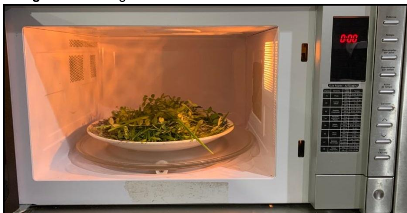
Figura 22: Secagem da amostra do consórcio no micro-ondas.
